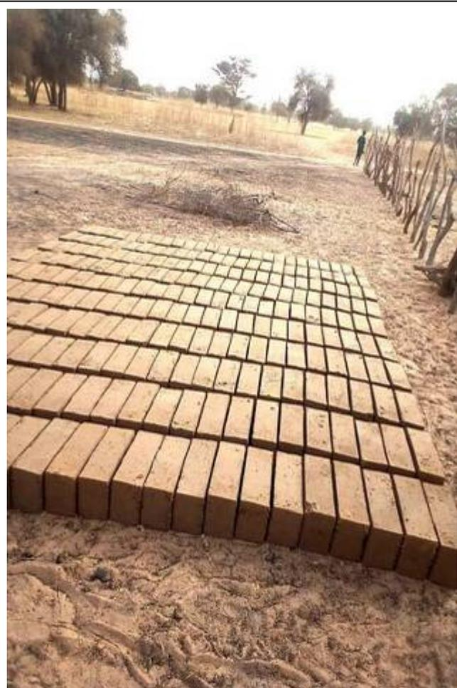
Au Sénégal, les « Briqueurs » moulent / fabriquent les agglo béton directement sur le chantier.
